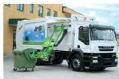
Figura C – 6 Compattatore a carico laterale
