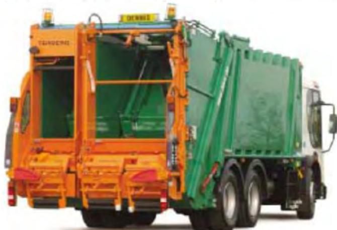
Figura C -7 Compattatore multiscoparto
