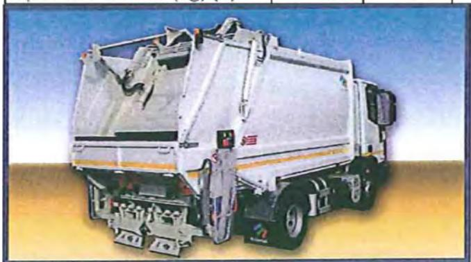
Figura C – 5 Compattatore a carico posteriore
