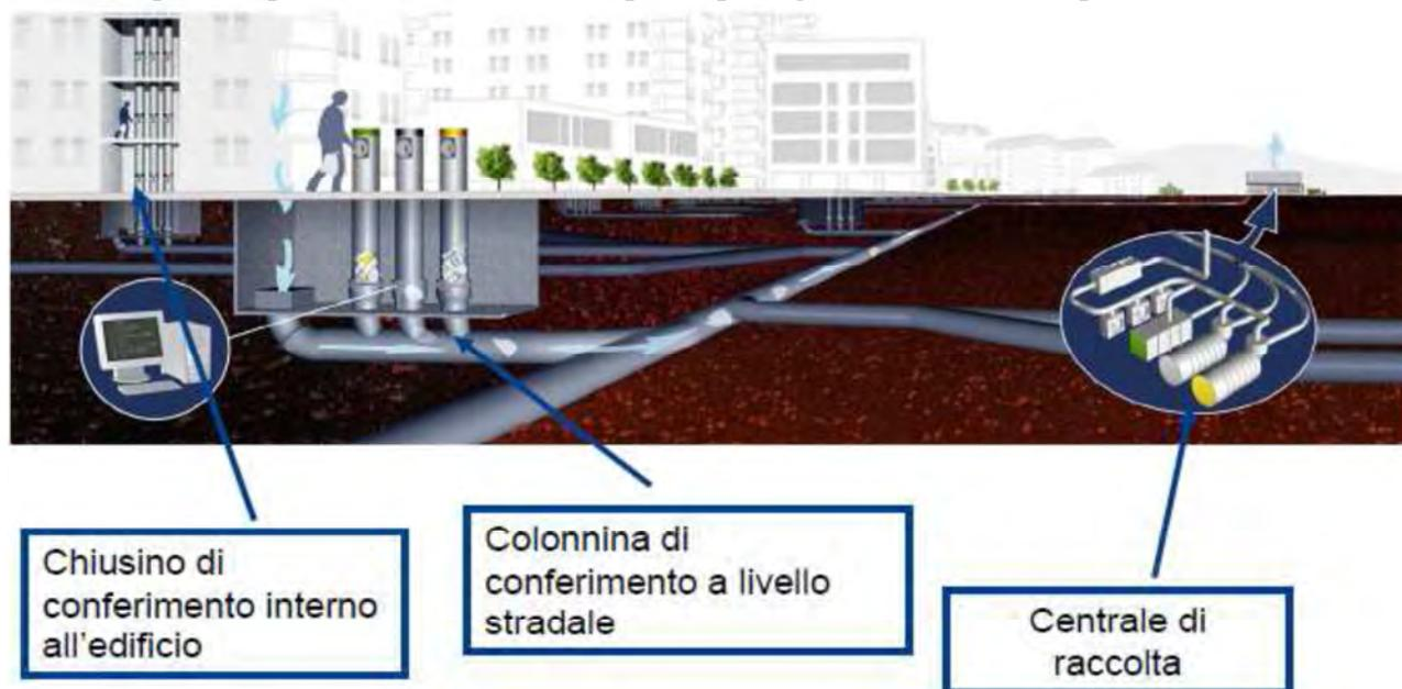
Figura 14 Esempio di sistema di raccolta “pneumatico”
