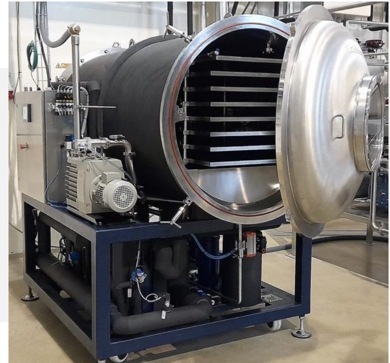
130 kg, Freeze Dryer Unit (Inovlinea, Tagusvalley, Abrantes, Portugal)
